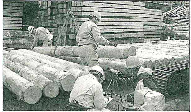
図2 縦振動法による強度性能評価 マイクロフォン 供試材：丸太、ラミナ 硬質プラスチックハンマ FFTアナライザ
